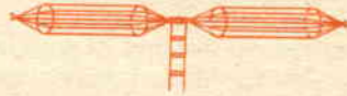
Fig. 2 - Dipolo a più fili di tipo a gabbia. Anche se è rappresentata una discesa bifilare, questa antenna può essere adattata ad una discesa convenzionale, con cavo coassiale da 52 \Omega .
